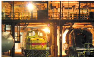
BEFÜLLUNG DER TORPEDOWAGEN Torsten Lange, Altforweiler.
