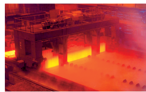
BRAMMENKÜHLBECKEN Joe Szymczak, Dinslaken
